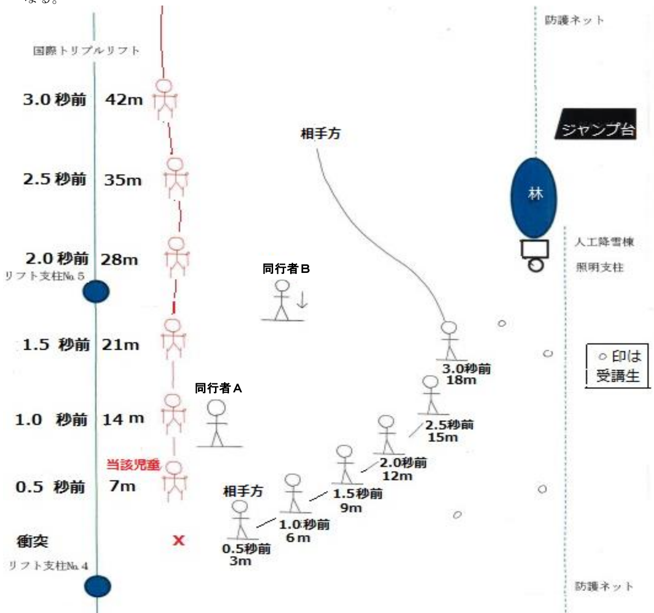
図Ⅲ-4-6 衝突時までの位置概念図-当該児童 (50.4km/h) と相手方 (21.6km/h) の経過位置
