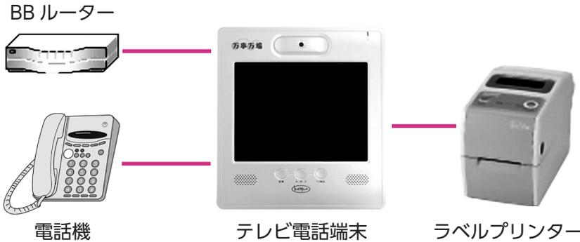
生産者の家庭に設置されたテレビ電話端末は、道の駅からの情報（売れ筋情報など）の確認から、端末を操作しバーコードラベルの印刷、集荷要請までできます。設置者間でのテレビ電話も可能です。
