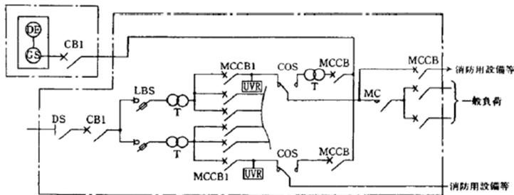
注 UVR は、MCCB 1 から自動切替装置までの間に設けること。
