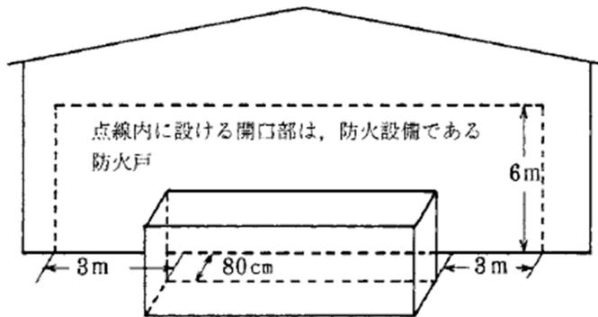
(c) 変電設備と相対する外壁との間に、変電設備の側方1m以上、高さ2m以上となる防火上有効な不燃材料で造ったへいを設けたもの。
