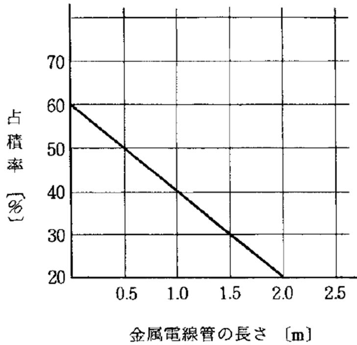
なお、電線管の長さは実際の火災の場合に加熱されると考えられる部分 (L) の長さ ((5)において同じ。) をいう。(例 1～5 参照)
