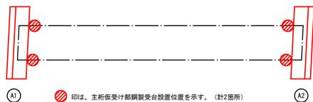
印は、主桁仮受け部鋼製受台設置位置を示す。(計2箇所)
